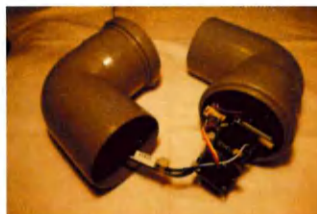
Im Rahmen von MINToringSi entstandene selbstgebaute Feinstaubmessstation
